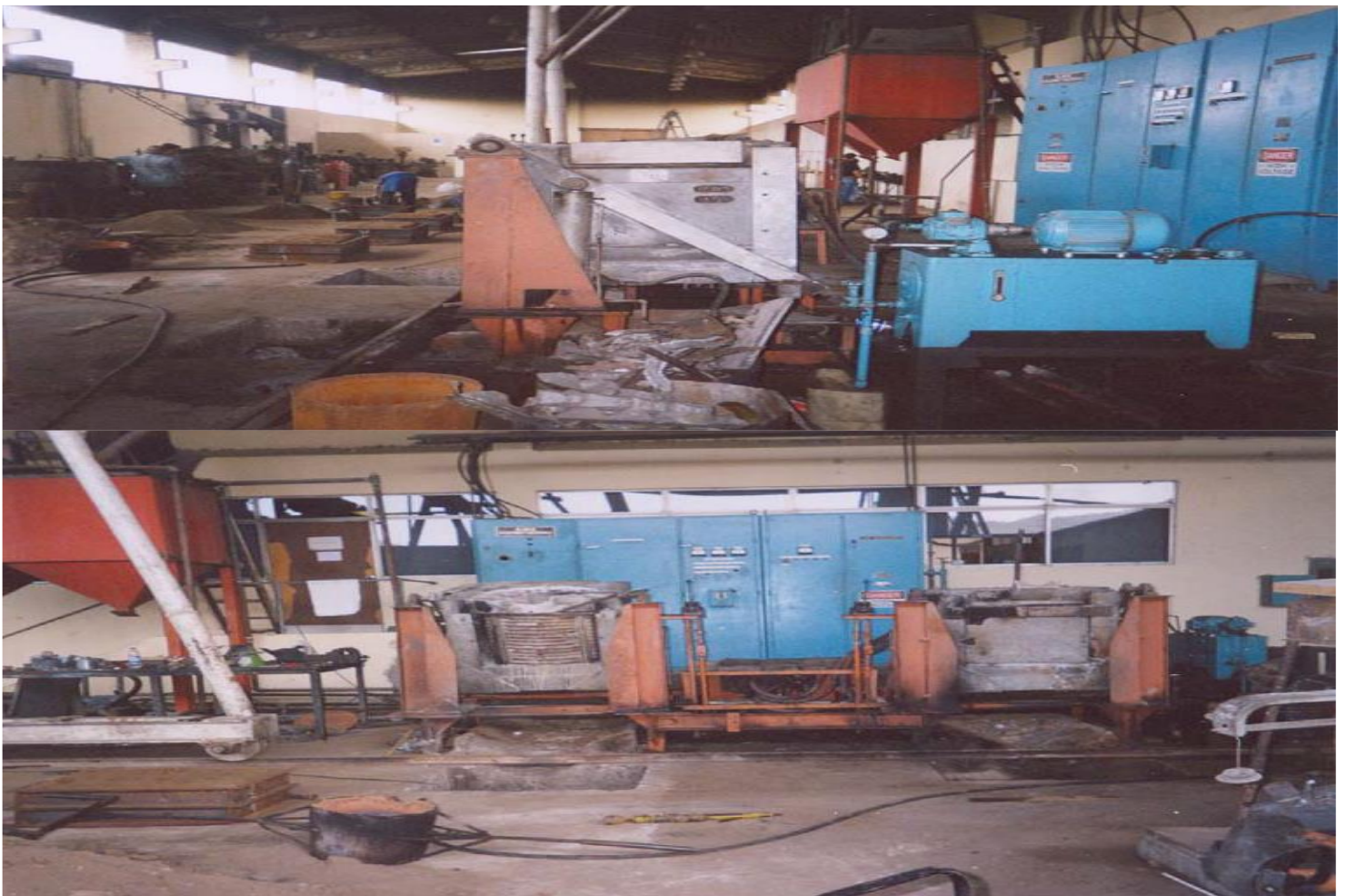
Figura. 2.37. Banco operativo de un horno de inducción de baja frecuencia.
