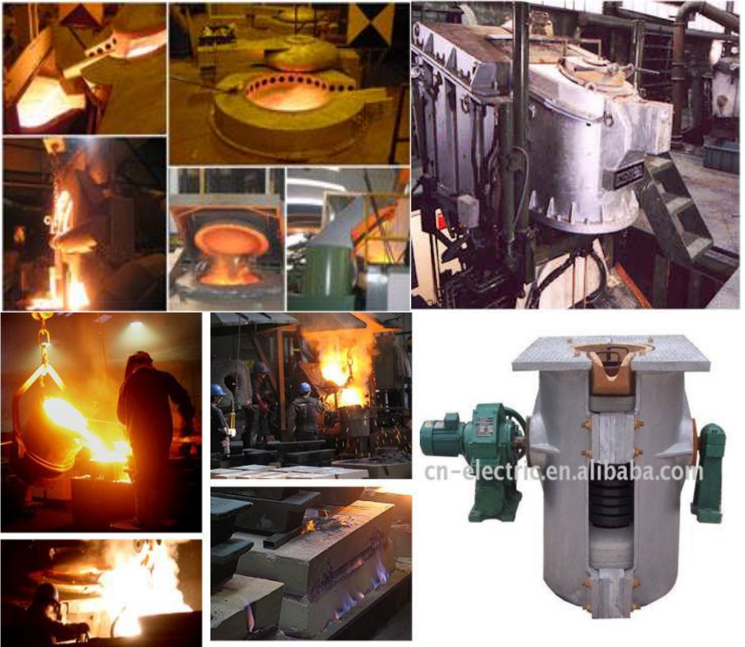
Figura. 2.34. Aplicación de los Hornos de Inducción de Alta Frecuencia.
