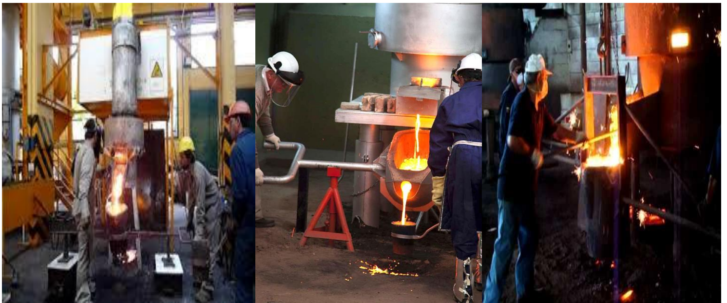
Figura 2.17. Empleo en la industria de los Hornos de Cubilote para la producción de diversos tipos de hierro.
