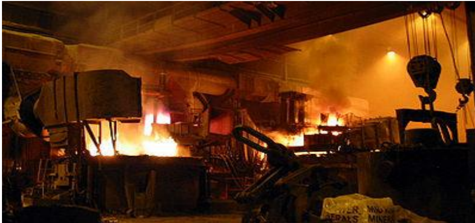
Figura. 2.25. Taller de fundición con dos hornos de arco eléctrico.
