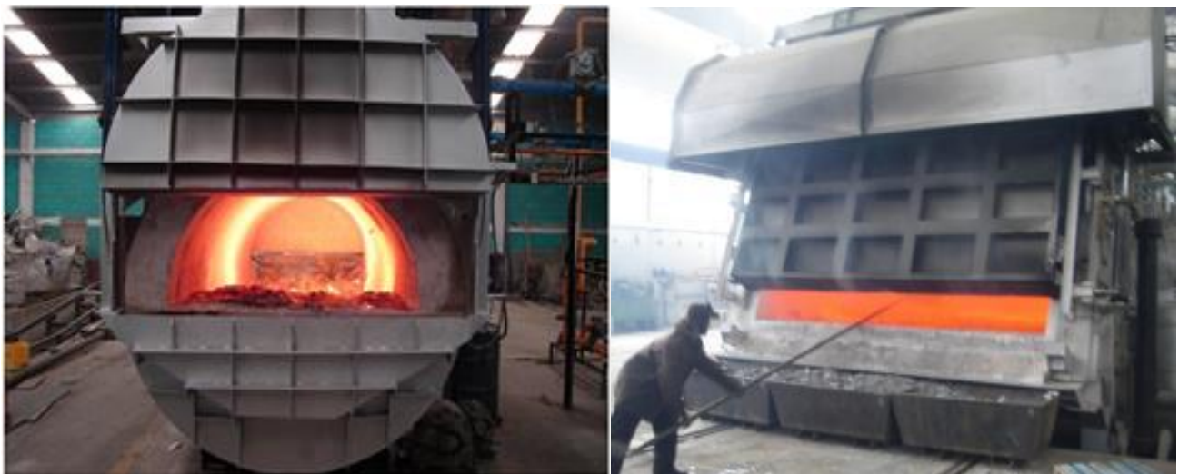
Figura 2.23. Hornos de Hogar Abierto para fundición de aluminio.
