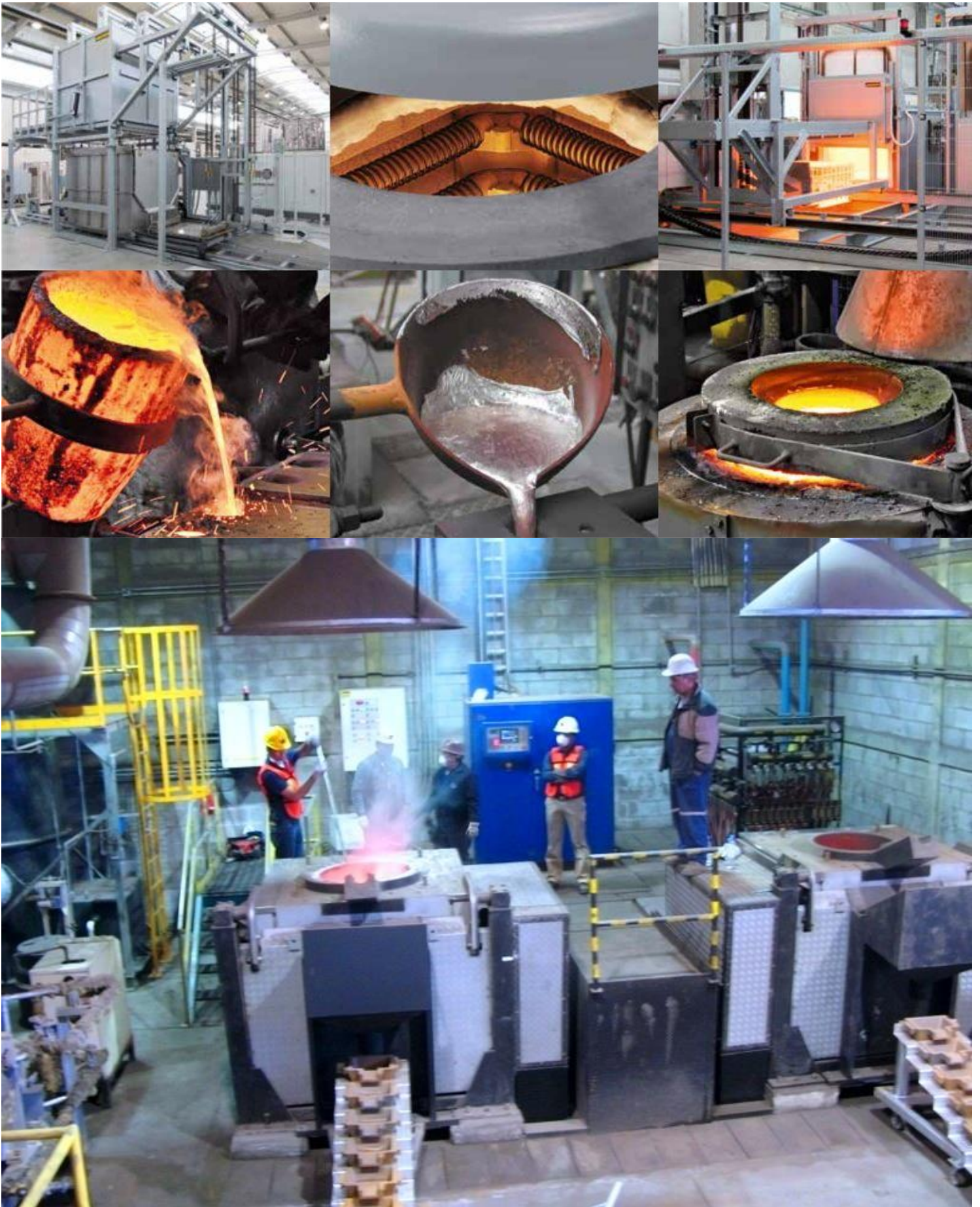
Figura 2.10. Hornos industriales para fundición.
