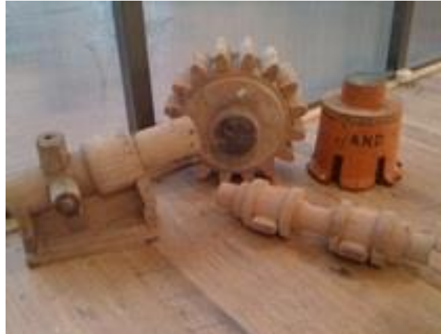
Fig. 1.13. Modelos de Madera.
