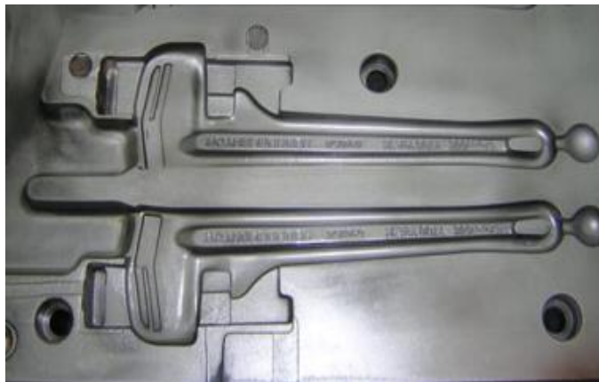
Fig. 1.5. Ejemplo de modelos de una sola pieza.
