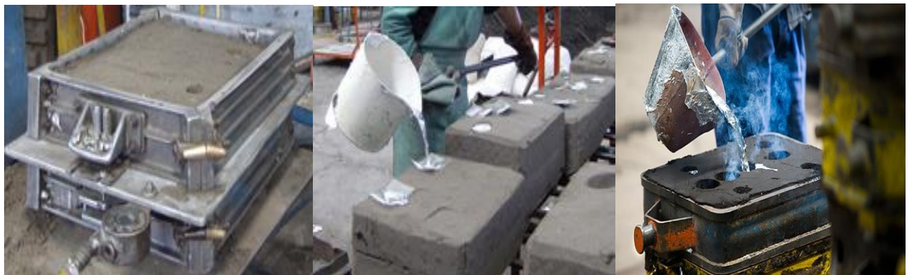
Fig. 1.26. Ejemplos de Moldes en arena en verde.
