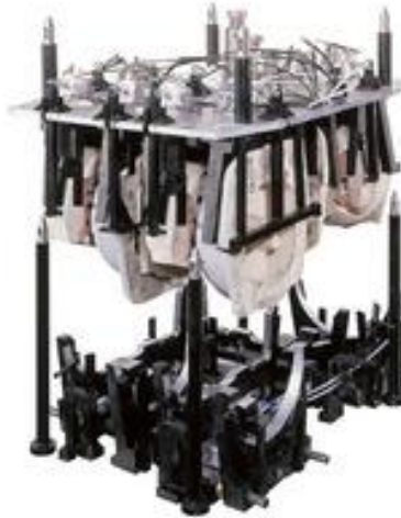
Fig. 1.2. Utillaje es un conjunto de instrumentos y herramientas que optimizan la realización de las operaciones de proceso de fabricación
