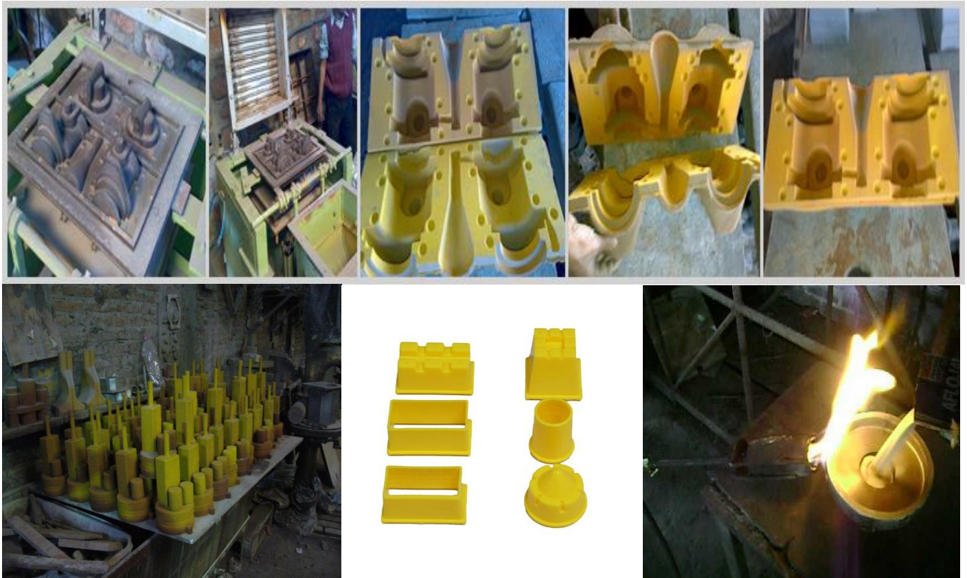
Fig. 1.29. Modelos para vaciado en moldes en cascara (Shell).
