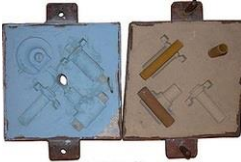
Fig. 1.11. Ejemplo de modelos con caja de corazones.
