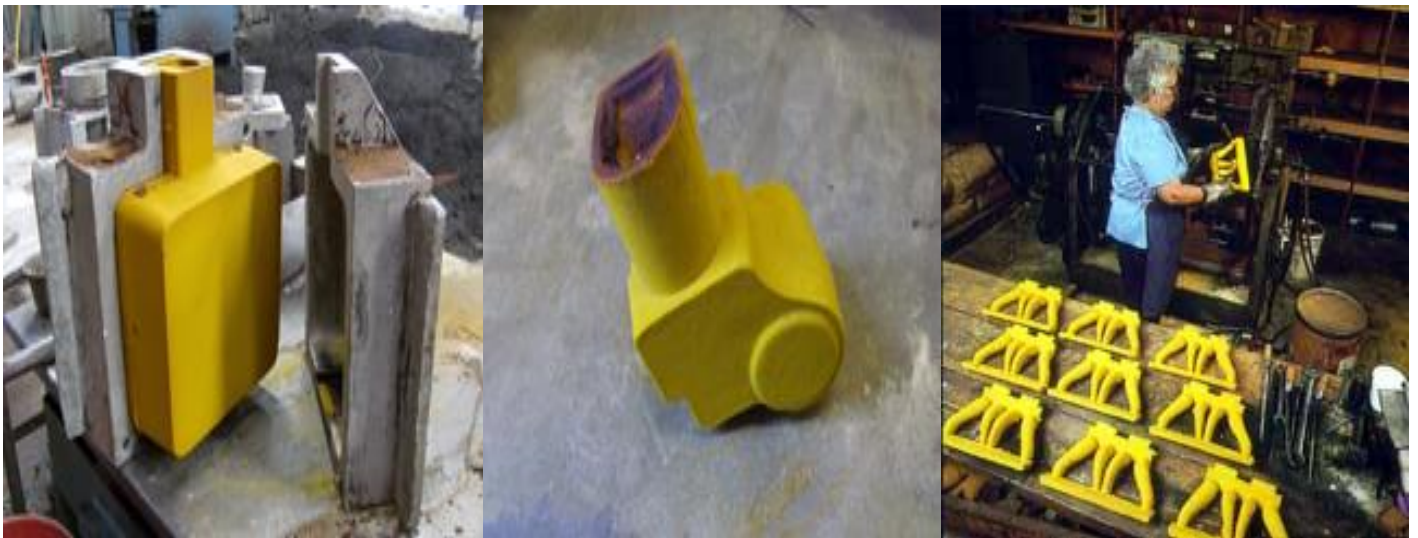
Fig. 1.28. Ejemplos del moldeo en cascara (Shell).
