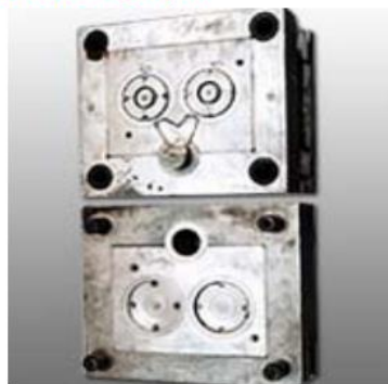
Fig. 1.41. Fundición en molde permanente.
