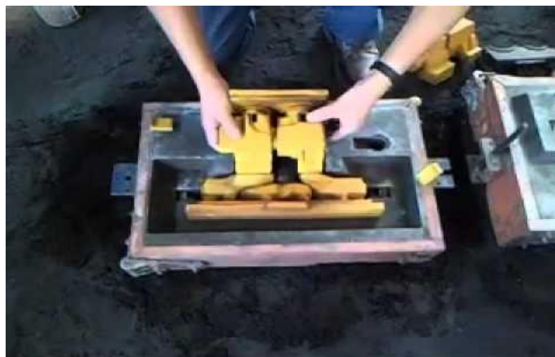
Figura 1.20 - a. Caja modelo sencillo de madera de dos piezas
