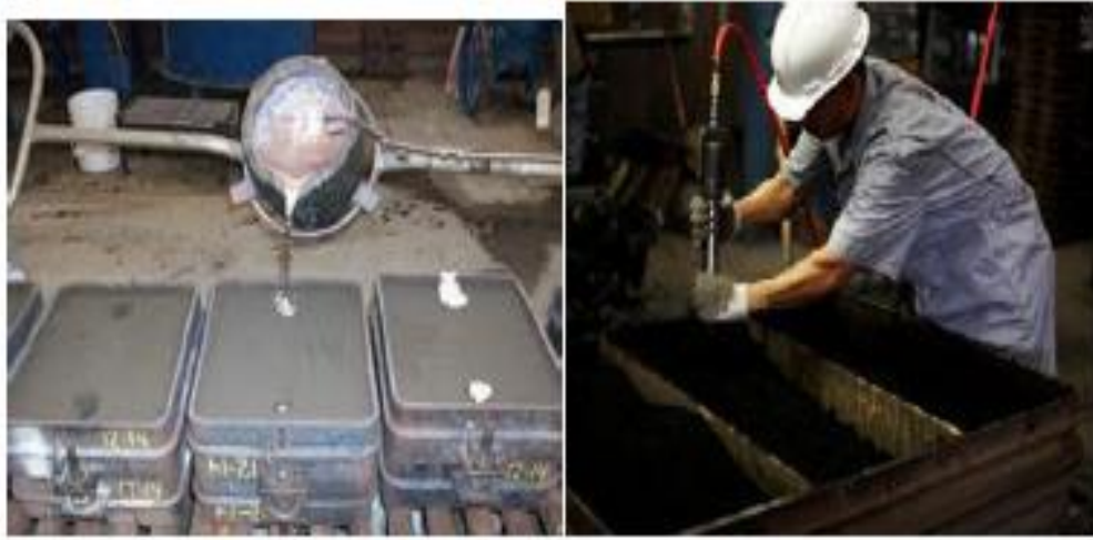
Fig. 1.22. Izquierda vaciado de aluminio en moldes de arena en verde. Derecha, compactado de la arena alrededor del modelo.
