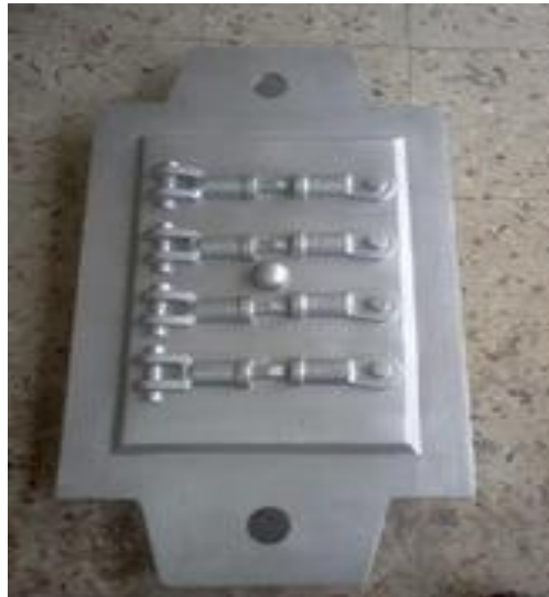
Fig. 1.9. Ejemplo de modelos placa modelo.
