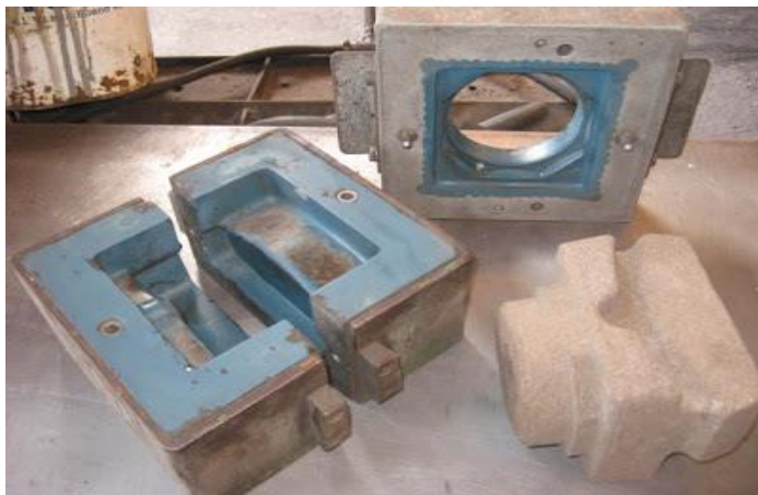
Fig. 1.39. Ejemplos de moldes Silicato con \text{CO}_2 .
