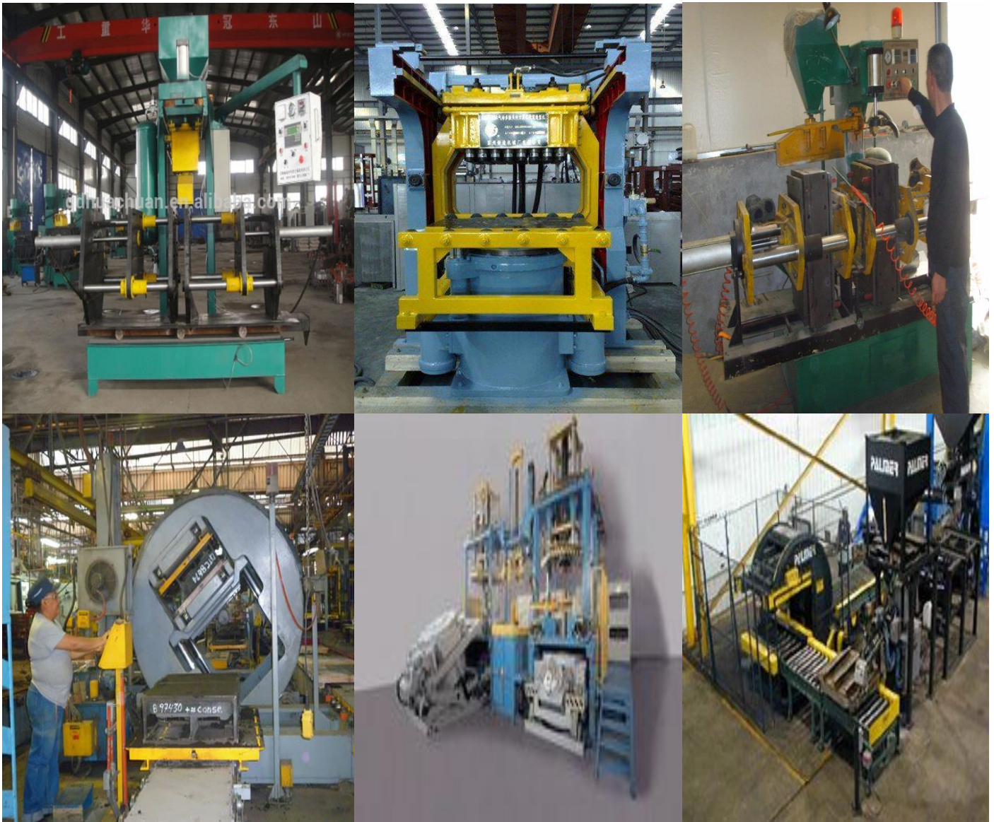
Fig. 1.30. Máquinas para la fabricación de moldes en cáscara (Shell).
