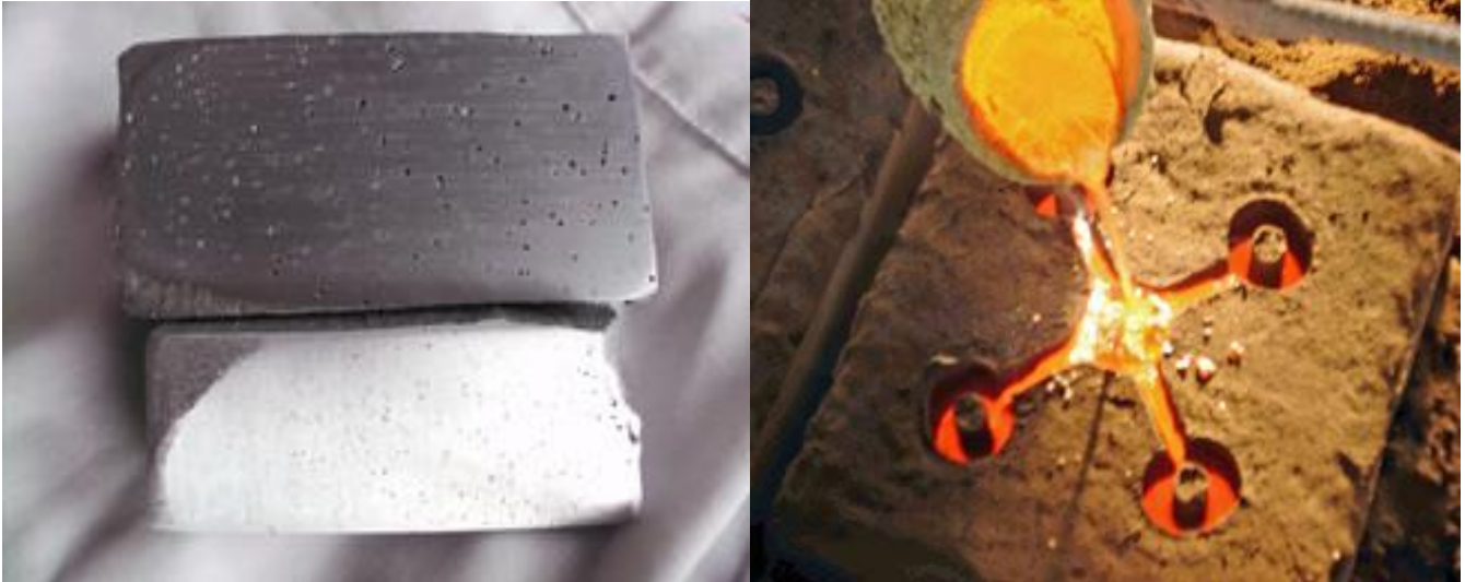
Fig. 1.18. Contracción metálica de los Modelos.
