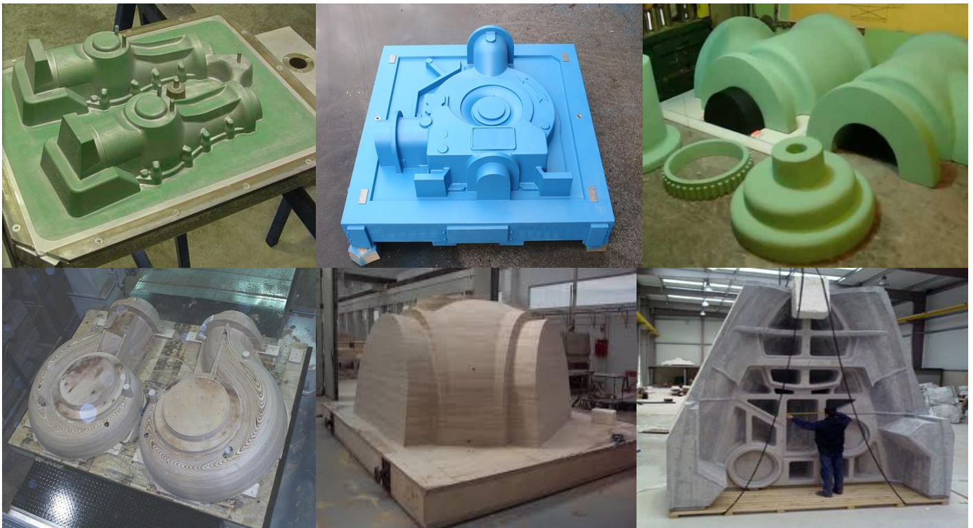
Fig. 1.43. Ejemplos de modelos de metal.
