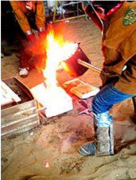
Fig. 1.23. Moldeo manual: Operarios realizando el vertido del metal en el molde
