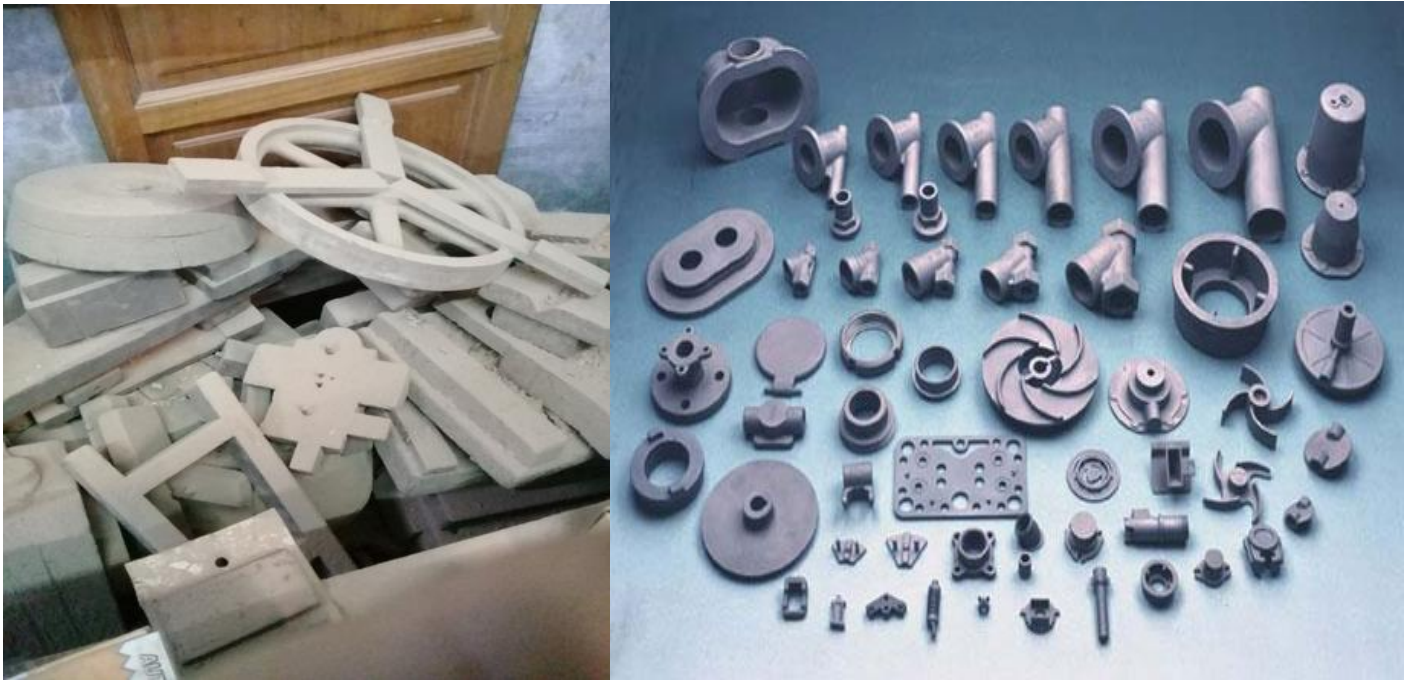
Fig. 1.1 - a. Ejemplos de Modelos: Muestra del modelo y de las piezas finales
