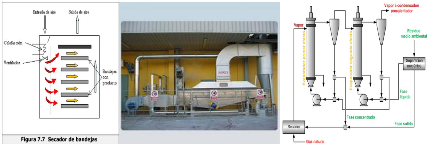
Fig. 10. Ejemplos de secadores industriales de calentamiento directo discontinuo.
