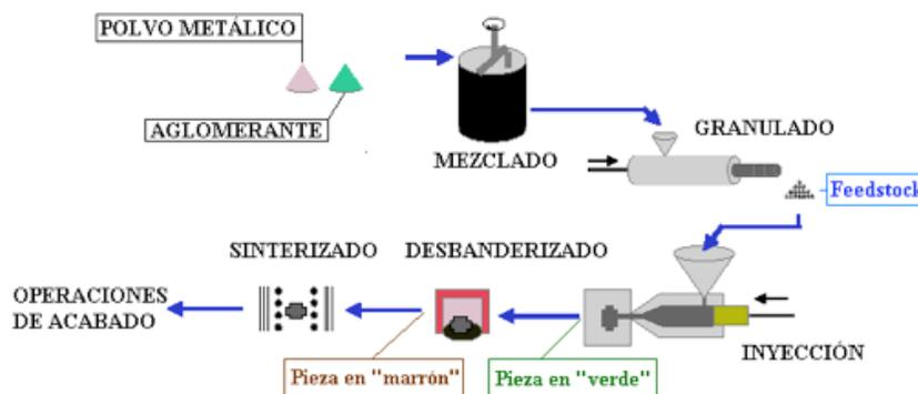
Figura 5.39. Descripción del método de sinterizado de biomateriales cerámicos.
