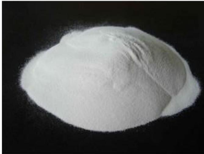
Figura 5.19. Óxido de aluminio o alúmina ( $\text{Al}_2\text{O}_3$ ).
