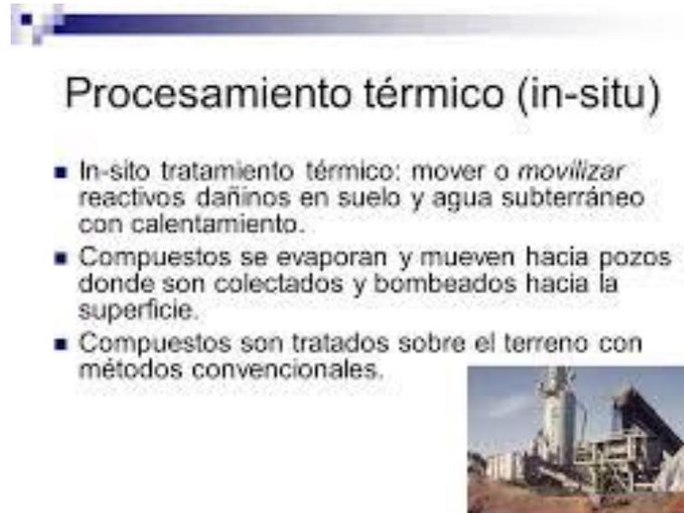
Figura 5.37. Descripción del método de procesamiento in situ.
