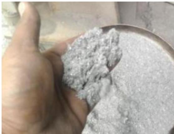
**Figura 5.21. Aspecto característico del óxido de aluminio o alúmina (Al<sub>2</sub>O<sub>3</sub>).**
