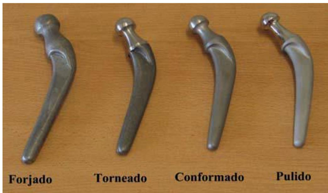
**Figura 4.20.** Cuatro pasos sucesivos en la fabricación de un tallo femoral de una prótesis de la articulación de cadera
