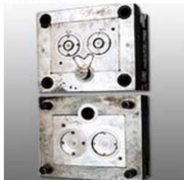
Molde metálico para la inyección de Aluminio
