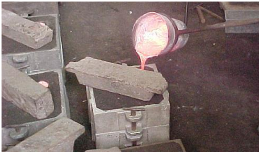
Izquierda vaciado de moldes de arena en verde. Derecha, compactado de la arena alrededor del modelo.
