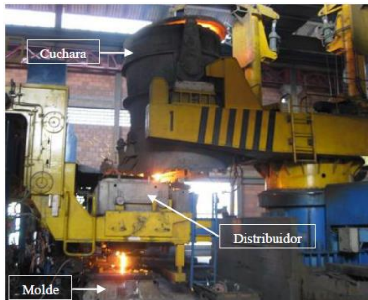
Vaciado de acero líquido al proceso de colada continúa
