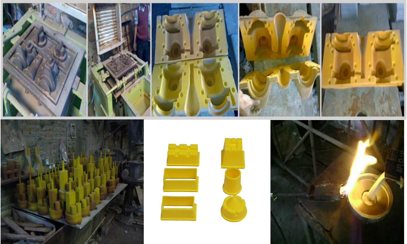
Modelos para vaciado en moldes en cascara (Shell).
