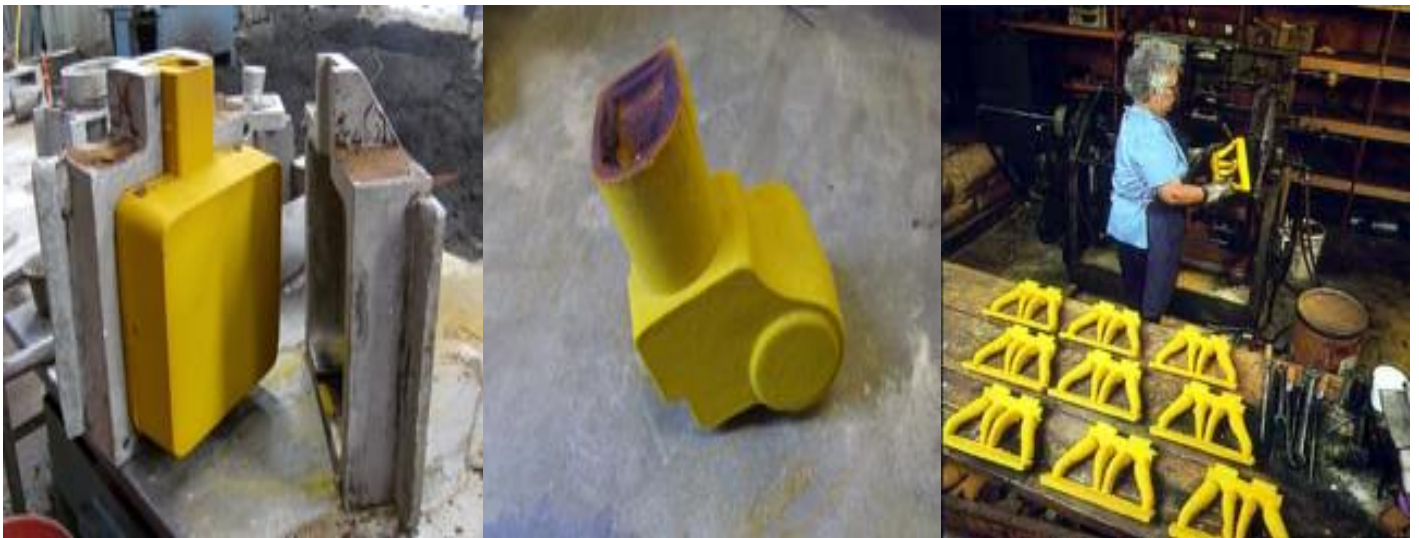
Ejemplos del moldeo en cascara (Shell).
