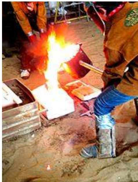
Moldeo manual: Operarios realizando el vertido del metal en el molde
