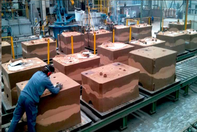
Ejemplos de moldeo manual y en máquina.
