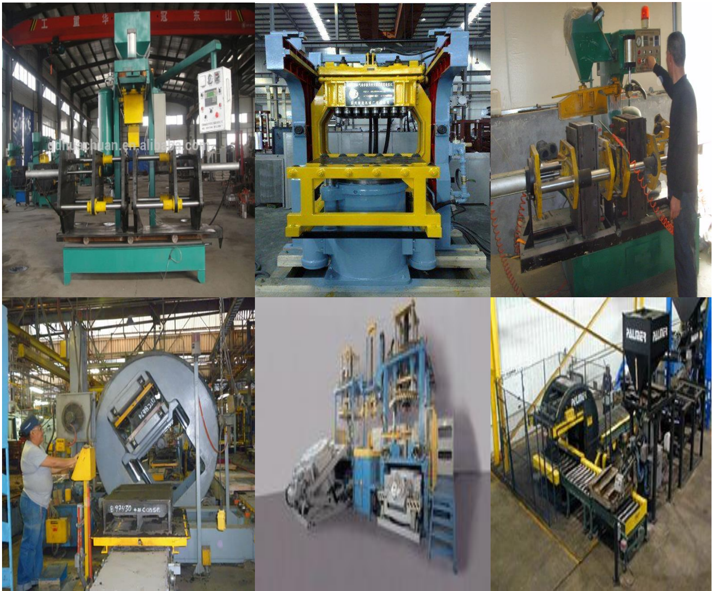
Máquinas para la fabricación de moldes en cascara (Shell).
