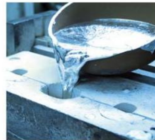
Colada por gravedad de Aluminio en molde metálico
