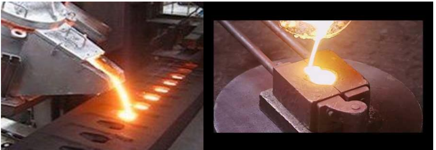
Ejemplos de moldes de metal.
