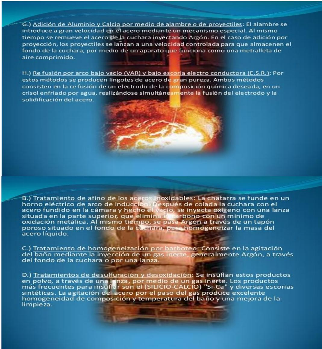
**G.) Adición de Aluminio y Calcio por medio de alambre o de proyectiles:** El alambre se introduce a gran velocidad en el acero mediante un mecanismo especial. Al mismo tiempo se remueve el acero de la cuchara inyectando Argón. En el caso de adición por proyección, los proyectiles se lanzan a una velocidad controlada para que almacenen el fondo de la cuchara, por medio de un aparato que funciona como una metralleta de aire comprimido.
