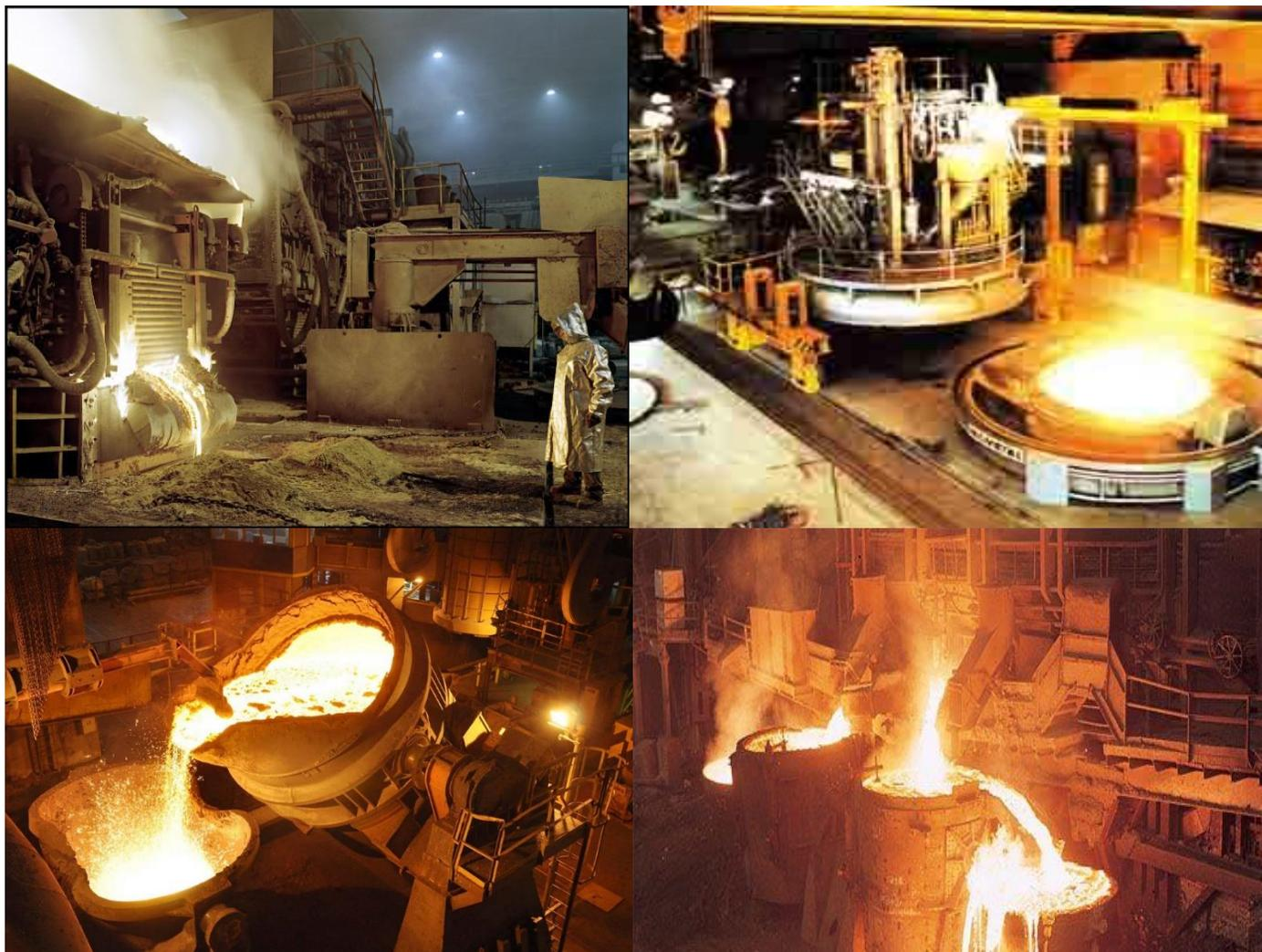
El acero procedente del horno eléctrico UHP es tratado mediante procesos por vacío o a presión atmosférica, ya sea en una cámara de vacío donde se introduce la cuchara o en la propia cuchara como se detallará más adelante. Existen diferentes tipos de tratamiento como veremos cuyo objetivo es desgasificar y ajustar en composición y temperatura el acero obtenido del horno UHP para generar la colada del acero ya libre de impurezas y con las especificaciones requeridas.
