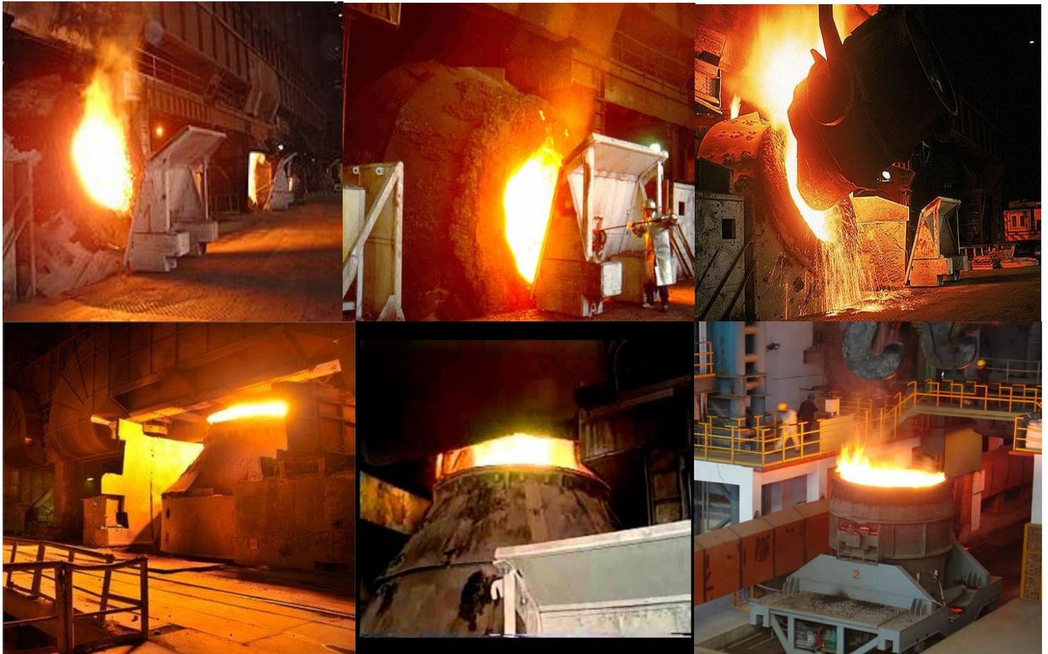
Figura. 3.13. Convertidores para el proceso Q-BOP Soplo Combinado y OBM.
