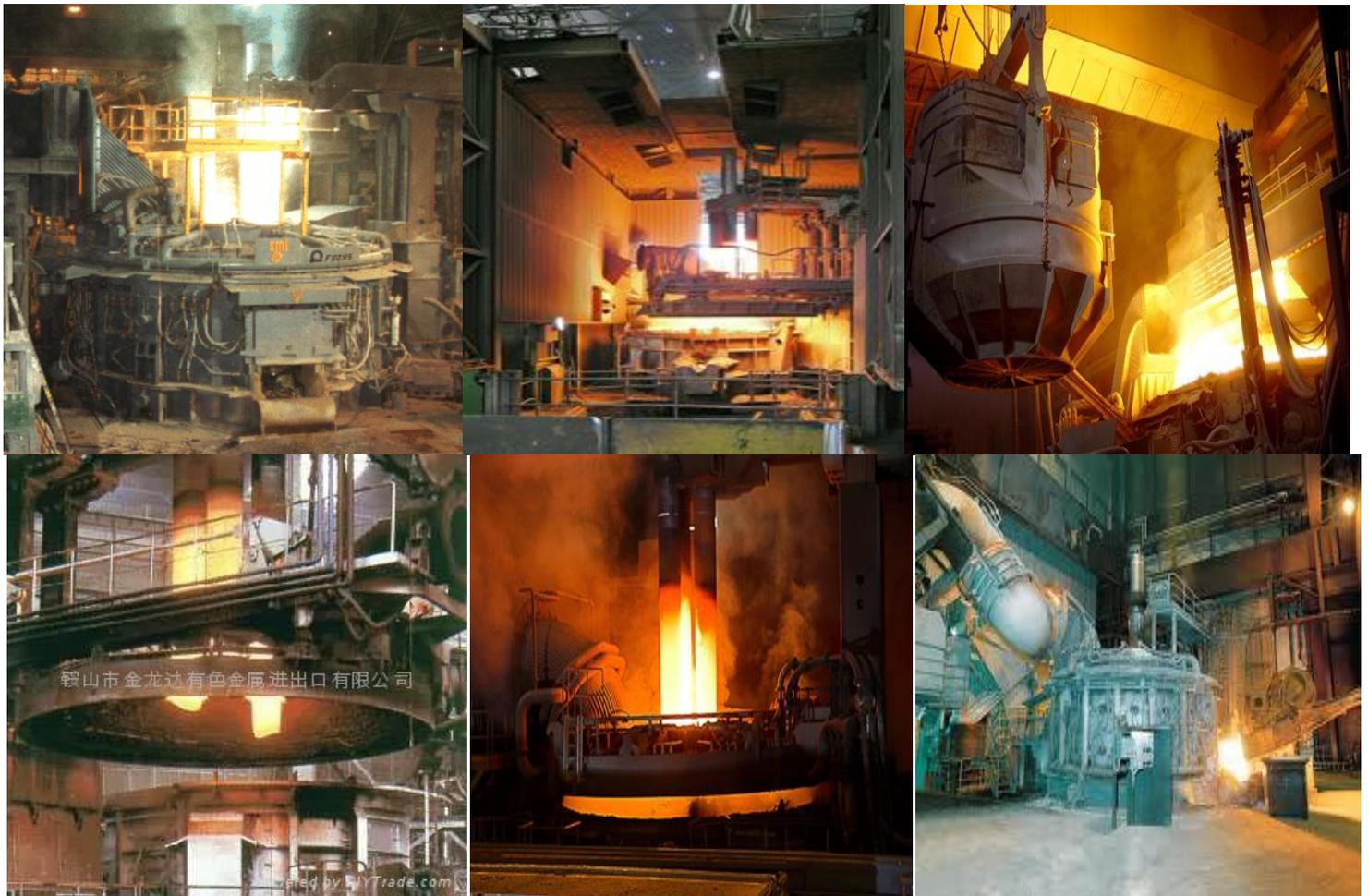
**Figura. 3.8. Tipos de Hornos de Arco Eléctrico.**
