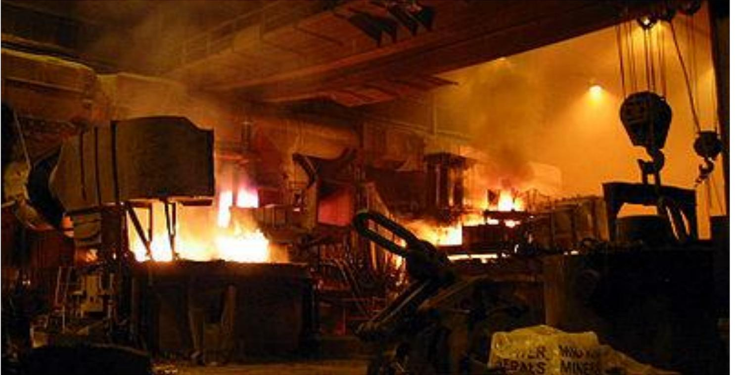
**Figura 3. 5. Taller de fundición con dos hornos de arco eléctrico.**
