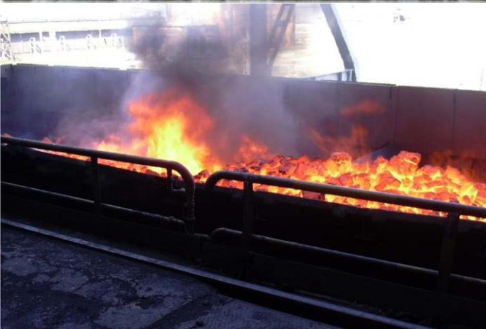
• La coquización es una forma energética de craqueo térmico utilizada para obtener gasolina de destilación directa (nafta de coquificador) y diversas fracciones de destilación intermedia, que se utilizan como materiales para craqueo catalítico. Por este proceso, el hidrógeno de la molécula de hidrocarburo se reduce de forma tan completa, que el residuo es una forma de carbono casi puro, denominado coque.
