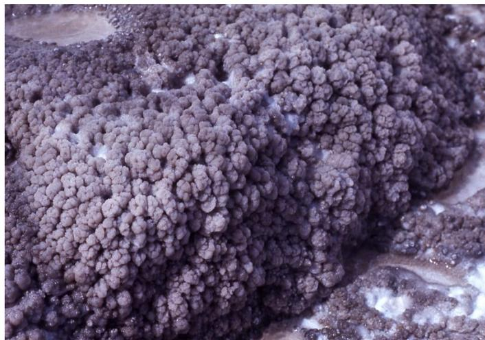
**Figura 4. Sinter para alto horno.**
