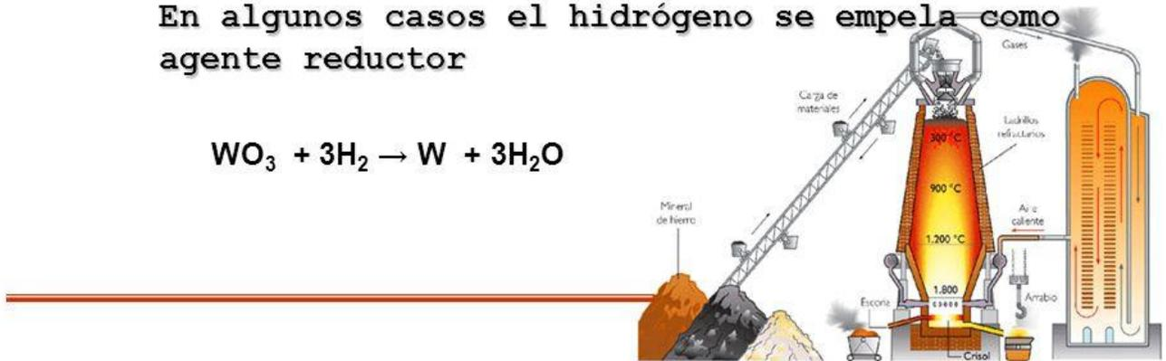
Fig. 15. Ejemplo de la reducción química de ciertos metales.
