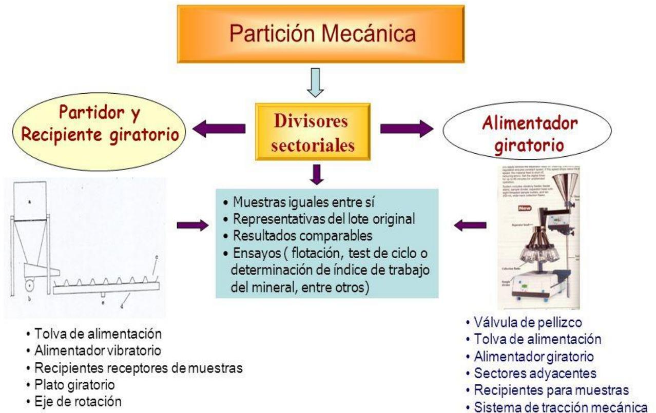
Fig. 2. Separación Mecánica de Minerales.
