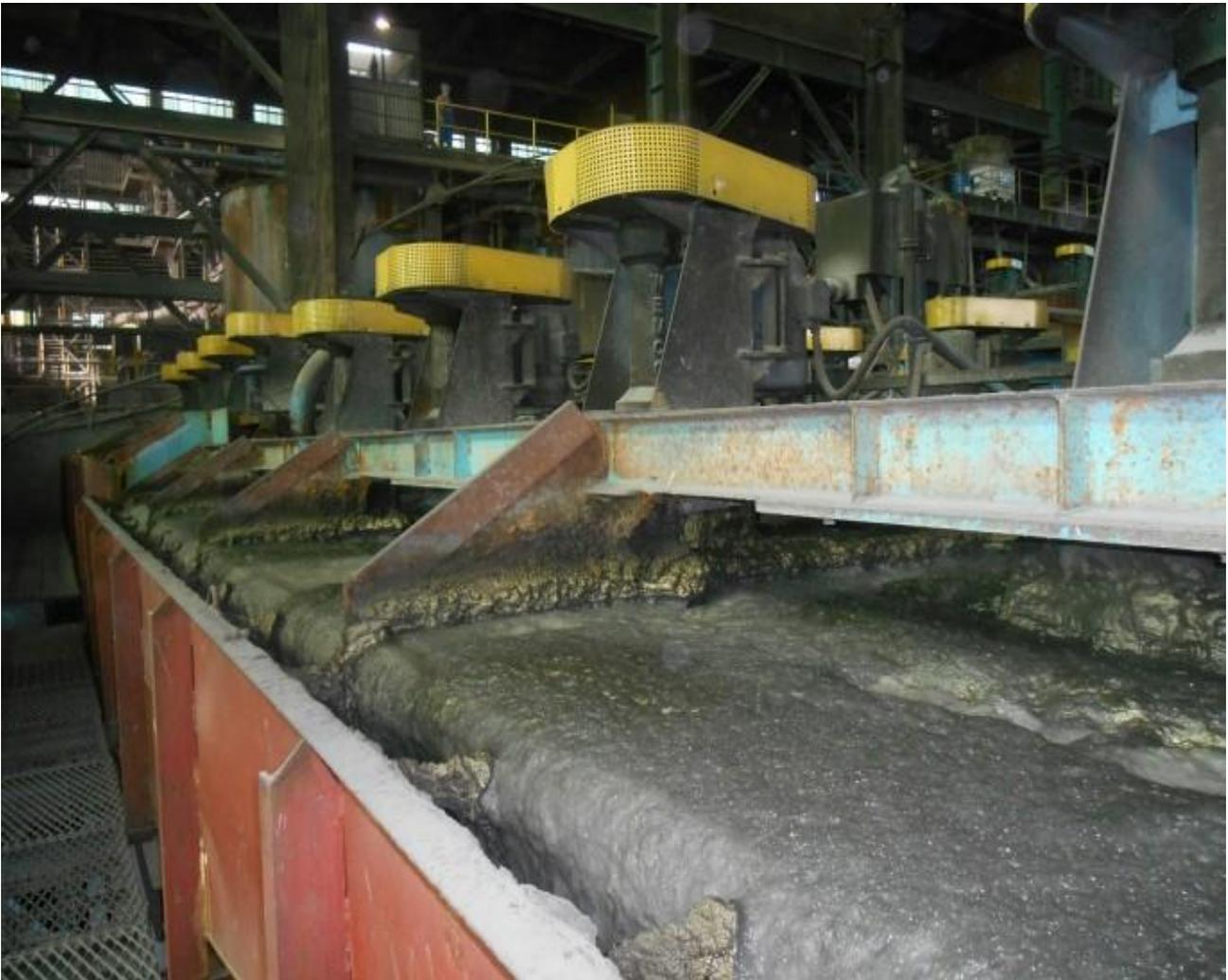
**Fig. 3. Flotación de Minerales.**
