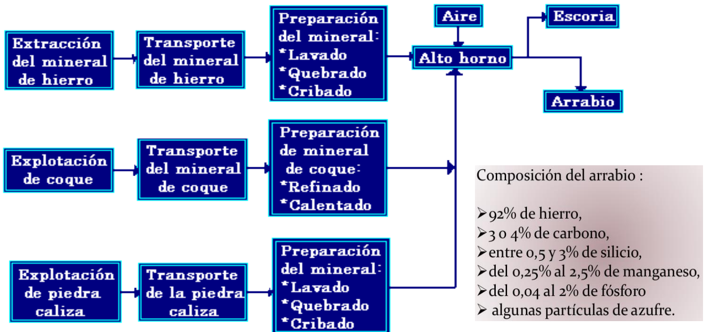
Figura 3.2.7. Diagrama del procesamiento y obtención de arrabio (composición típica).
